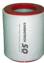
Envase de acero reutilizable con un contenido de 50 lbs de carbón activado para filtrar compuestos orgánicos volátiles (COV) y gases. Duplique el período de vida útil del filtro volteando el envase de arriba hacia abajo para permitir la distribución adecuada de contaminantes a través del medio.
