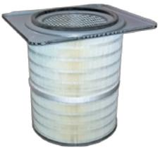
El eficiente filtro de cartucho MERV 15 captura partículas a nivel sub-micrométrico, y la tecnología de carga superficial permite que el polvo se desprenda fácilmente durante la limpieza con aire comprimido.
